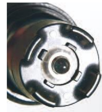
광범위한 pH 유리 전극 (HF-resistant 유리 전극도 사용 가능)
