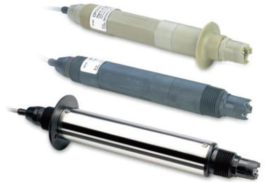
Hach 디지털 pH D sc 센서는 컨버터블 삽입 및 위생 본체 스타일로 사용할 수 있습니다. 전극 3개를 사용하여 측정 정확도를 향상시키며 센서 접지 루프가 필요 없습니다.
